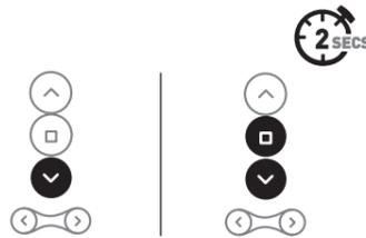
Déplacez le store jusqu'à la limite inférieure souhaitée en appuyant plusieurs fois sur la flèche vers le bas . Ensuite, appuyez et maintenez enfoncés les boutons bas et STOP pendant 2 secondes pour enregistrer la limite.
