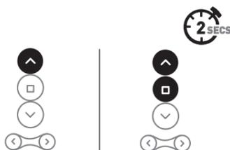
Déplacez le store jusqu'à la limite supérieure souhaitée en appuyant plusieurs fois sur la flèche vers le haut . Appuyez ensuite simultanément sur les touches haut et STOP pendant 2 secondes pour enregistrer la limite.
