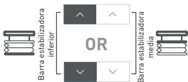
Para invertir el sentido de la persiana, mantenga presionadas las teclas **ARRIBA** y **ABAJO** hasta que el motor responda.
