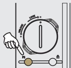
Drücken Sie die Taste P2 am Steuergerät
