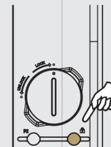
Drücken Sie den Schalter in die verriegelte oder entriegelte Position.
