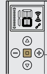
Wenn Sie die gewünschten Einzelkanäle hinzugefügt haben, drücken Sie die STOP-Taste, um die Änderungen zu bestätigen. Der obere Bildschirm wird 4 Sekunden lang angezeigt
