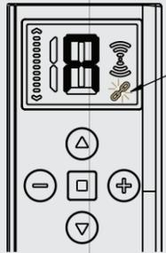
Die Fernbedienung befindet sich nun im Gruppen-Kanalanzeigemodus. Das Verknüpfungssymbol blinkt, und die hinzugefügten Einzelkanäle werden angezeigt.
