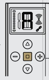
Tippen Sie zweimal auf die Stop-Taste, nicht auf die Nivelliersteuerungsleiste. Drücken Sie nun die Taste Auf oder Ab, um den gewünschten Prozentsatz der Verdunkelung einzustellen. Nach 2 Sekunden bewegt sich die Verdunkelung/en auf diesen Prozentsatz zu.
