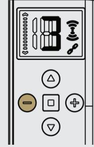
Mit der Taste [-] schalten Sie die Zuweisung zum Gruppenkanal ein/aus. Hinweis: Der Gruppenkanal-Indikator weist darauf hin, dass ein Kanal hinzugefügt wurde.
