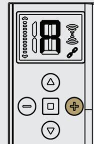
Scrollen Sie durch die Kanäle 1-15 und wählen Sie einen Gruppenkanal von A-E zur Ansicht
