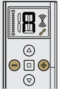
Drücken Sie die Tasten [+ ] und [- ], um durch die hinzugefügten Kanäle zu scrollen.
