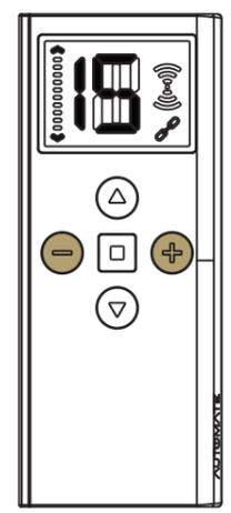
Wählen Sie den zu programmierenden Kanal, indem Sie mit den Tasten (+) oder (-) durch die Kanäle scrollen
