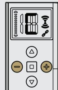
Wählen Sie die Tasten + oder - und scrollen Sie durch alle Kanäle, die Sie ausblenden möchten
