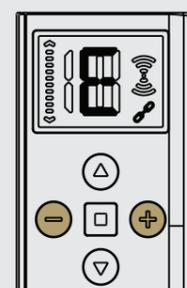
Drücken Sie 5 Sekunden lang die Tasten Kanal AUF und AB, bis im Display „E“ angezeigt wird.
