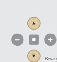
Bewegen Sie den Sonnenschutz in die gewünschte Position, indem Sie auf der Fernbedienung auf die Tasten AUF oder AB drücken.
