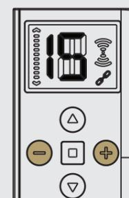
Halten Sie die Tasten Kanal AUF und AB 5 Sekunden lang gedrückt, bis im Display die ZiVer 15 angezeigt wird.
