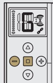
Halten Sie die Tasten [-] und STOP für 4 Sekunden gedrückt. Währenddessen wird im Display „G“ angezeigt. Zum Programmieren eines Gruppenkanals aus A-E wählen [Wenn 90 Sekunden lang keine Tasten gedrückt werden, beendet die Fernsteuerung diesen Modus]
