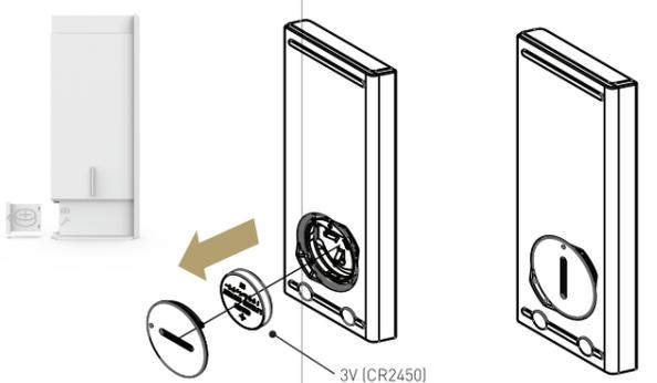
Drehen Sie den Batteriefachdeckel mit einer Münze/einem Werkzeug, das sich in der Ladestation befindet, zum Entriegeln und setzen Sie die Batterie mit der negativen Seite nach oben ein.
