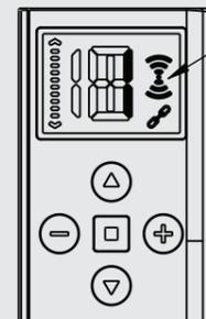
Die Fernsteuerung befindet sich jetzt im Gruppenkanal-Programmiermodus. Daraufhin wird das Signalzeichen und der Einzelkanal 1 angezeigt
