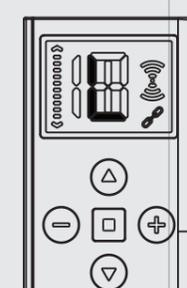
Durch Betätigen der Verriegelungstaste wird auf dem LED-Bildschirm zwischen verriegelt und entriegelt umgeschaltet.
